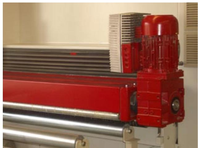
Rollenbahn mit Drehstrom-Asynchronmotor und Frequenzumrichter.
